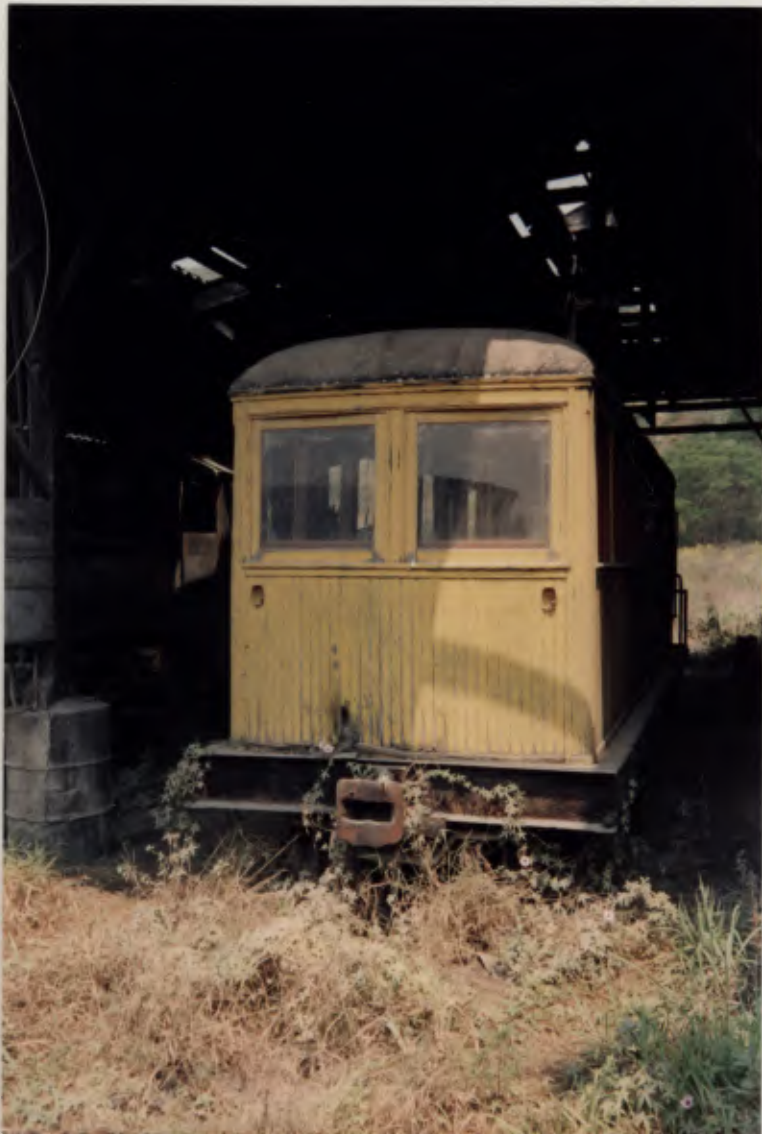
Foto 51: carro de passageiros com pintura original e vidros bisotados, abrigado sob galpão em estado precário, com telhado danificado (vide foto).
