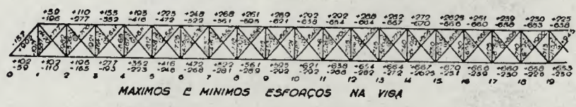
MAXIMOS E MINIMOS ESFORÇOS NAS DIAGONAIS MEIA VIGA Escala dos comprimentos Escala das forças
