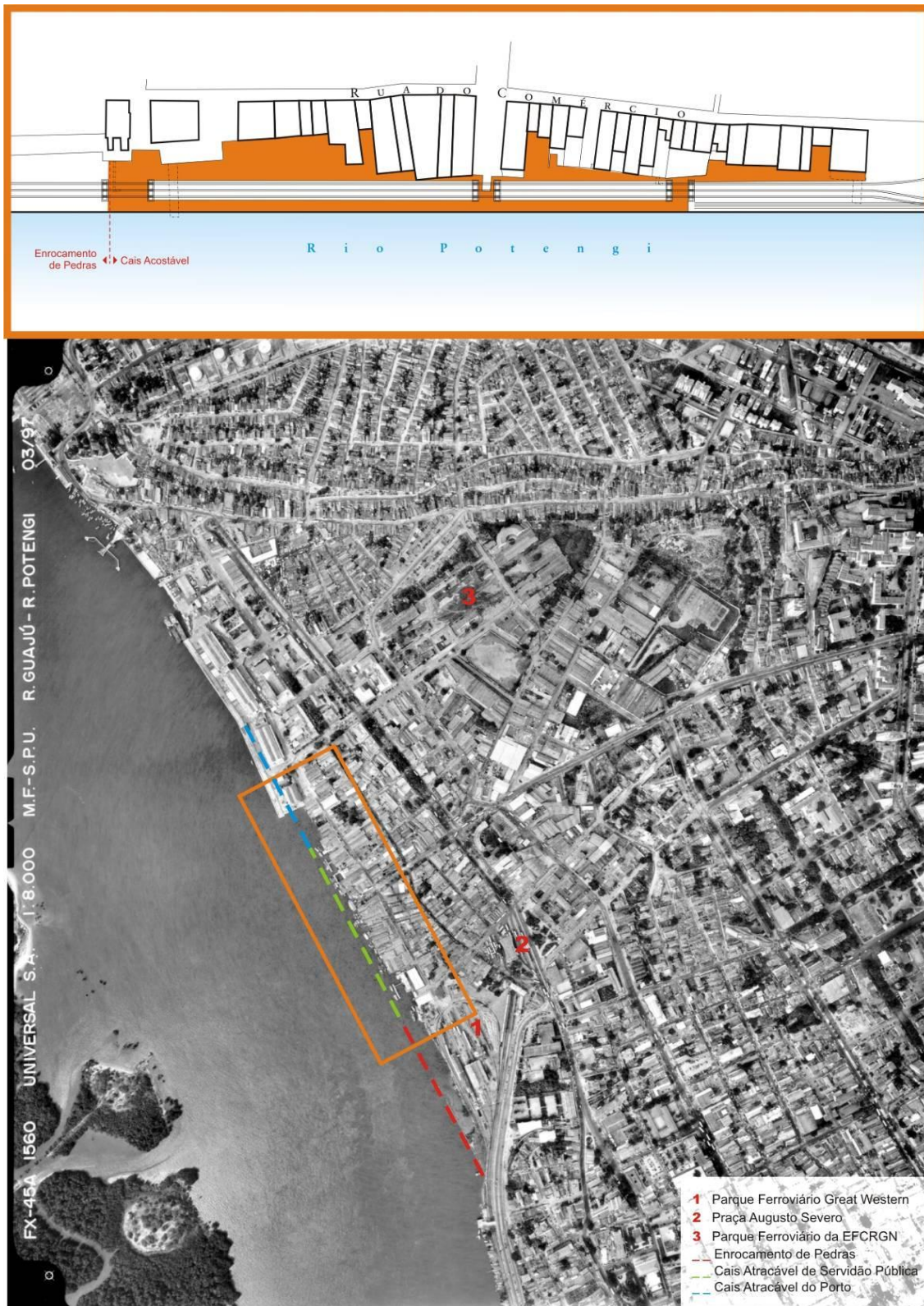
Fig. 10 – Projeto final do muro da EFCRGN. A zona demarcada em laranja mostra a área conquistada do rio que teria servidão pública. Notar que há três pontos de passagem previamente determinados sob os trilhos, um em frente à Alfândega,
