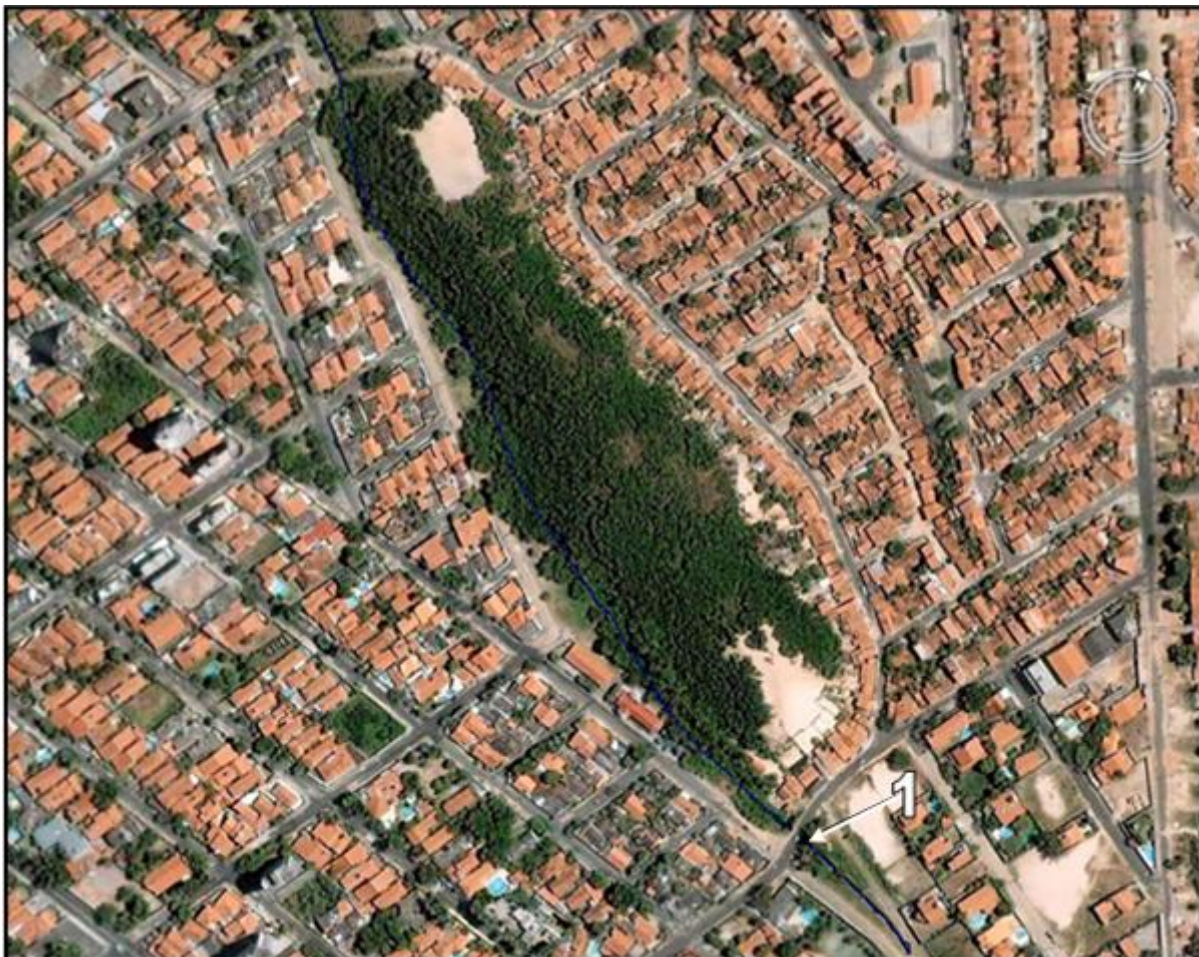
Figura 21 – Riacho Papicu, encosta da duna do Morro Santa Terezinha. 1 – final do canal concretado aberto e início do curso natural do riacho Fonte: imagens Quickbird 2003
