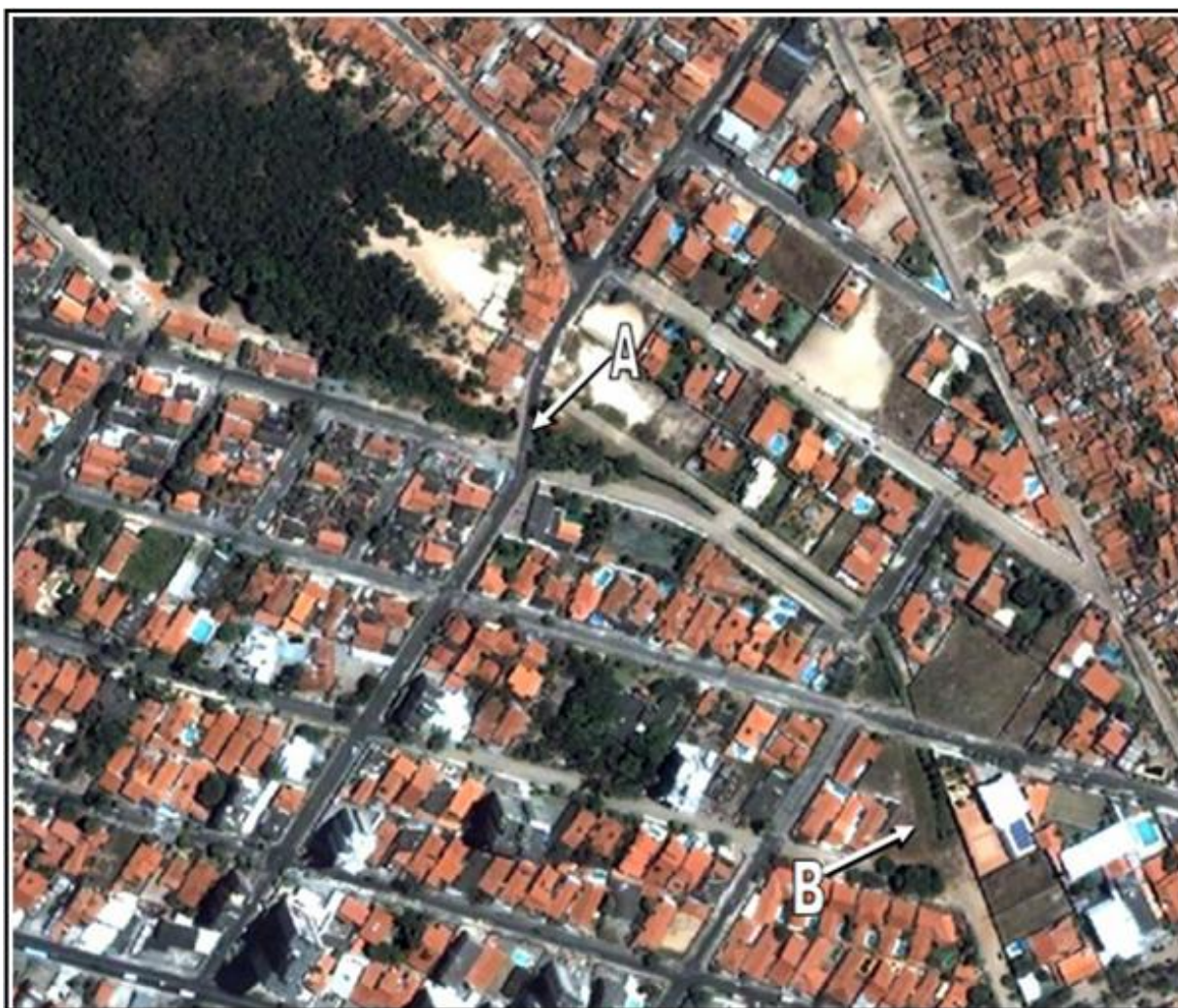
Figura 20 – Riacho Papicu, trecho canalizado em canal de concreto aberto. A – final do canal aberto concretado e início do curso natural do riacho; B – final da galeria subterrânea e início do canal aberto concretado Fonte: imagens Quickbird 2008.
